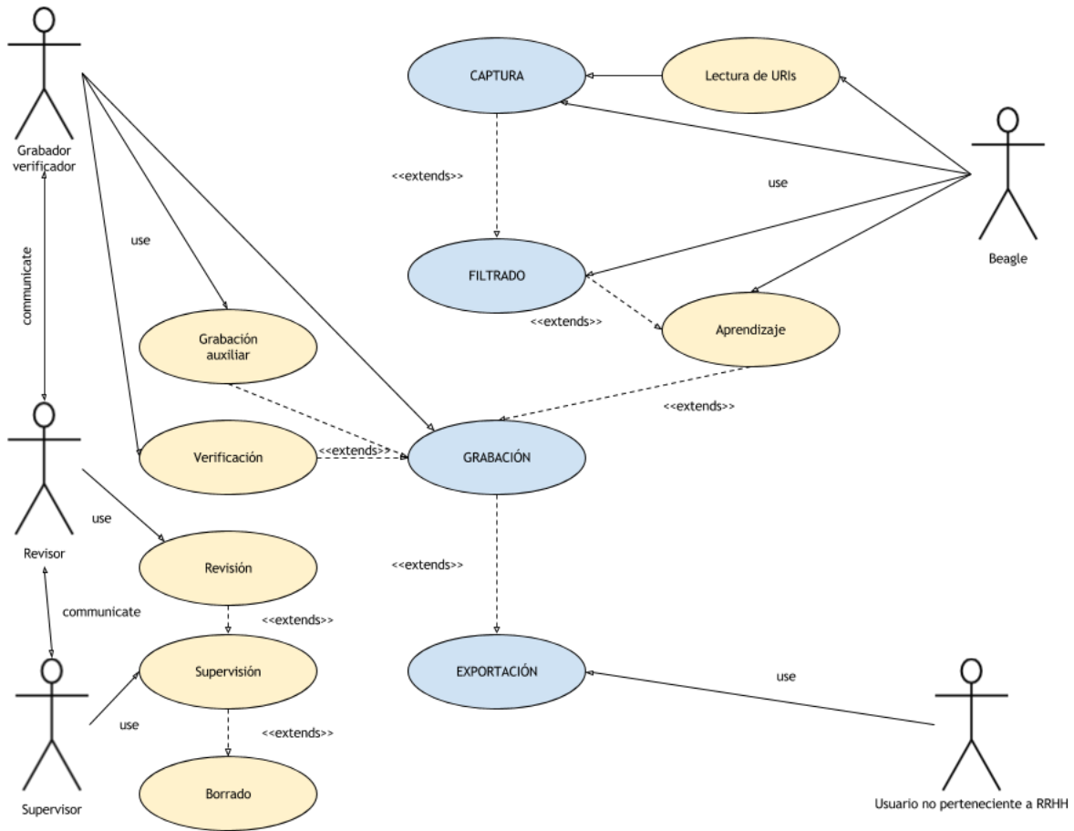
Ilustración 22. Diagrama UML genérico. Modelo de casos de uso
